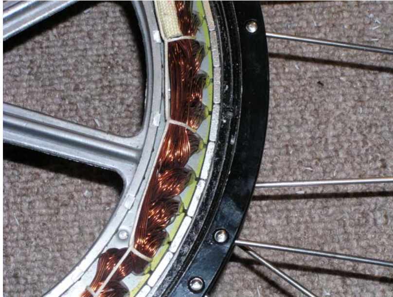
Řez elektrickým motorem s permanentními magnety
